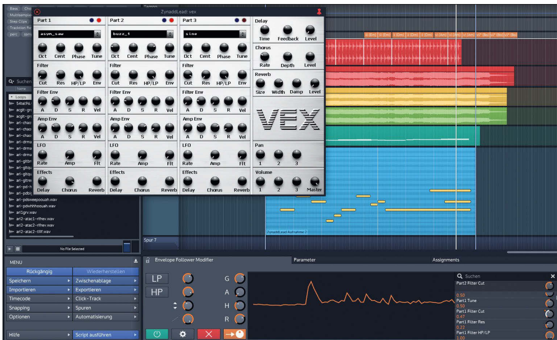
8 Der VST Synth VEX mit von einem Envelope Follower modulierten Filter.
