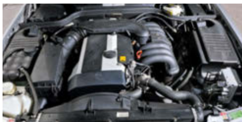
Freude in Rei(he)nform: Der M104 mit 2,8 oder 3,2 l Hubraum ist einer der kultiviertesten Mercedes-Motoren
