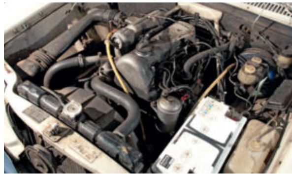
Mit dem M115 trägt der 230.4 eine ungewöhnliche Typenbezeichnung. Zeitgleich war ein 230.6 erhältlich, dann mit antikem M180-Sechszylinder aus den 50ern
