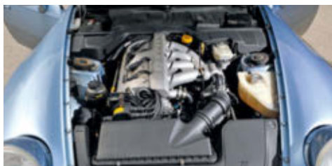
Der Dreiliter-Vierzylinder bietet dank des großen Hubraums und einer Nockenwellenverstellung viel Dampf
