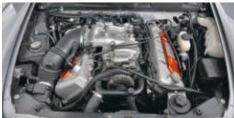
Der 4,6-Liter-V8 der vierten Ford-Mustang-Generation ist kein drehfauler US-Klops: 324 PS bei 6000 Touren
