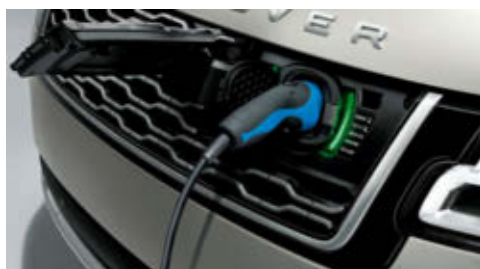
Ladebuchse am Bug, der Akku unter dem Kofferraum. Die Ladezeit beträgt zwischen 2:45 und 7:30 Stunden
