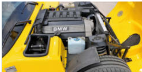
Viel Motor mit wenig drumherum. Das hochfeine BMW-Triebwerk M50-B25 stammt aus der Großserie
