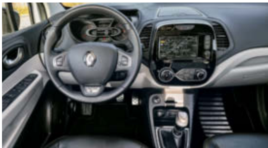
Die Ergonomie des Cockpits leidet unter der weitflächigen, bisweilen verwirrenden Verteilung vieler Funktionstasten
