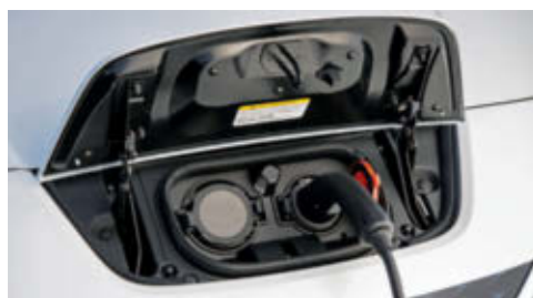
Wie beim Vorgänger fand der Stecker zum Aufladen seinen Platz hinter einer Klappe an der Fahrzeugfront
