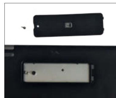
Dank eines freien Slots lässt sich im Medion Akoya E3222 eine m.2-SSD mit SATA-Anschluss nachrüsten.
