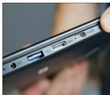
Links sitzen die Buchse zum Laden des Akkus, ein USB-3.0-Anschluss, eine HDMI-Buchse und ein USB-C-Anschluss.
