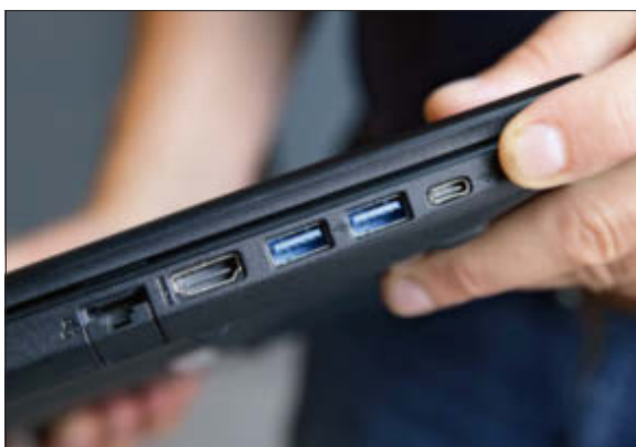
Links hat das Medion einen Netzwerkanschluss, eine HDMI-Buchse, zwei USB-3.0-Anschlüsse und eine USB-C-Buchse.
