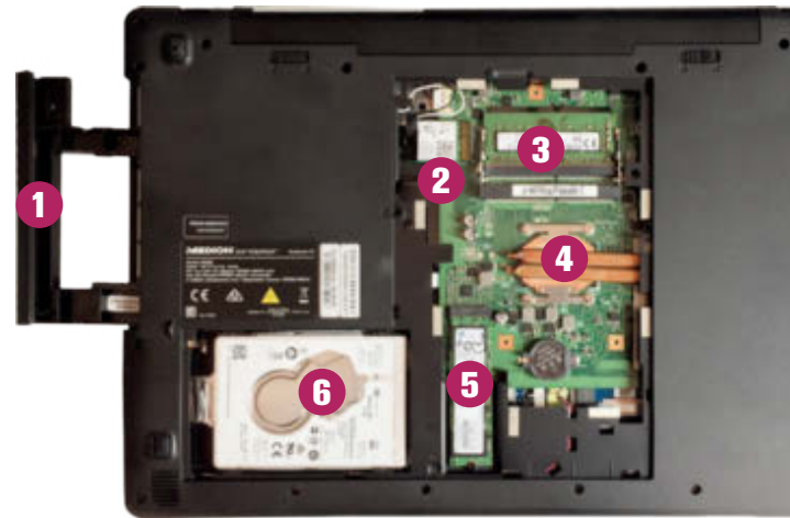
Im Detail: Einbaurahmen fürs Nachrüsten eines DVD-Brenners 1 , WLAN-/Bluetooth-Karte 2 , Arbeitsspeicher 3 , Prozessor 4 , SSD 5 und Festplatte 6 .
