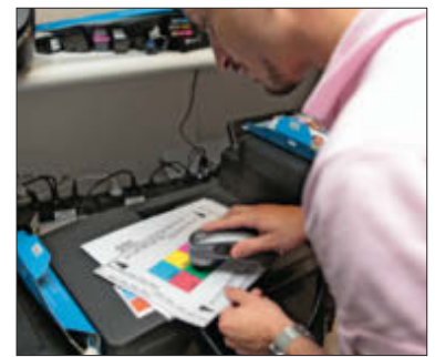
Verfälschter Druck? Ob die Geräte Farben originalgetreu drucken, prüften die Tester mit dem Messgerät X-Rite.
