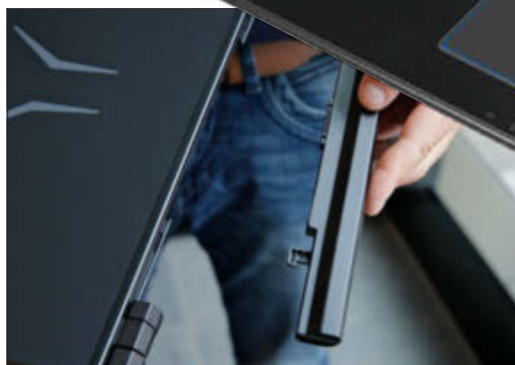
Nicht selbstverständlich bei aktuellen Notebooks: Ist der Akku defekt, lässt er sich problemlos gegen einen neuen tauschen.
