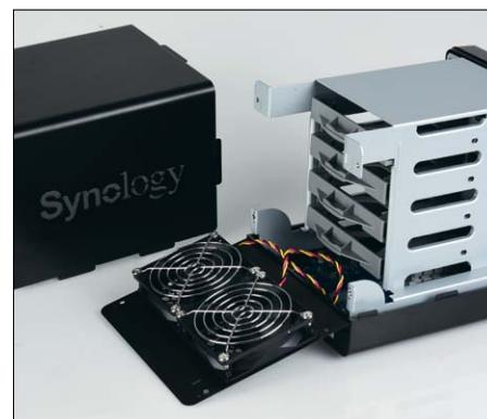
Um bei der Synology DS418j die HDDs zu verbauen, muss das Gehäuse geöffnet werden.
