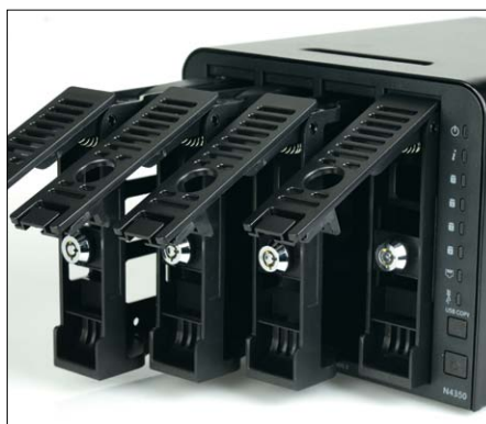
Bei Thecus werden die HDDs in den Rahmen eingebaut und dann bequem eingeschoben.
