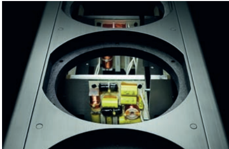
Die Frequenzweiche der Standboxen ist recht komplex ausgefallen. Piega verwendet erkennbar nur sehr hochwertige Bauteile.
