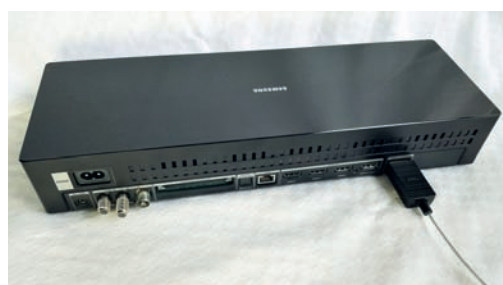
Jetzt mit Netzteil: Die Anschlussbox kann im Radius von fünf Metern zum Fernseher aufgestellt werden. Optional kann man auch ein 15 Meter langes Kabel für mehr Flexibilität anschließen.
