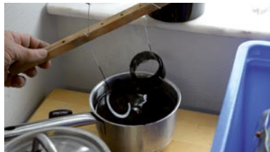
Um das Objektiv widerstandsfähig, rostfrei und haltbar zu machen, werden die Tubus-Teile zuerst anodisiert (links) und später eingefärbt (rechts).
