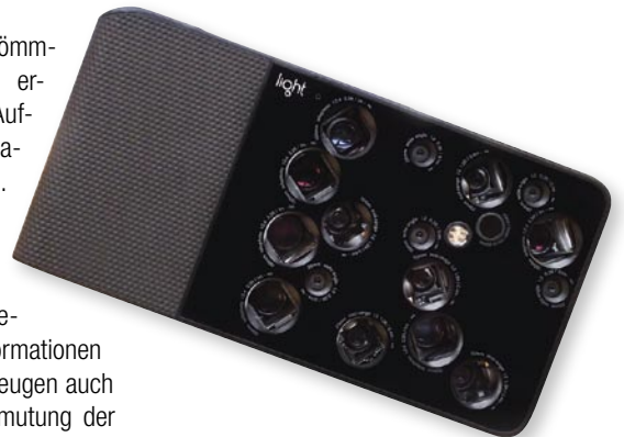
Die L16 von Light nutzt 16 Aufnahmemodule, die gemeinsam für die Aufzeichnung eines Bilds verwendet werden. Damit ist ohne optisches Zoomobjektiv die Einstellung unterschiedlicher Brennweiten möglich.
