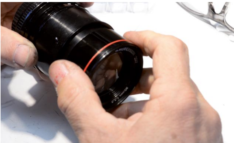
Schließlich werden die fertigen Teile des Objektivs miteinander verschraubt. In ihnen sind die einzelnen Glaselemente bereits fest installiert.
