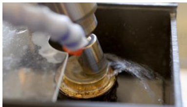
Der aus dem Glasblock gewonnene und auf Größe gebrachte Linsenrohling wird vorsichtig weiterbearbeitet, um eine erste ungefähre Krümmung zu erhalten. Dieser Arbeitsschritt wird „Kurvengenerierung“ genannt.
