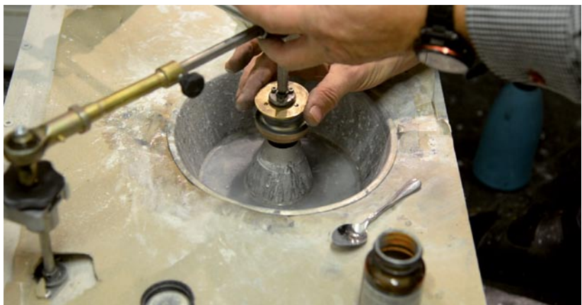
Die Schleif- und Poliermaschine hat Wernersson selbst gebaut. Mit ihrer Hilfe erhalten die Glaselemente ihre jeweilige finale Form.
