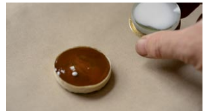
Das Werkzeug zum Polieren (links im Bild) wird hergestellt. Dafür drückte Wernersson die Bodenlinse (rechts) gegen eine mit Harz gefüllte Schale. Die weiße Flüssigkeit ist eine Aufschlämmung aus Wasser und Cerdioxid.
