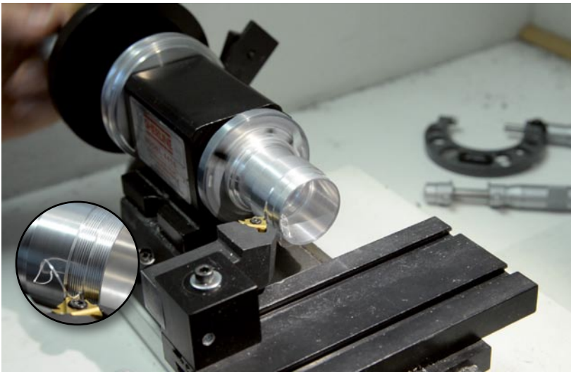
An der Drehbank wird der Objektivtubus bearbeitet und erhält etwa seine Gewinde zur Verschraubung. Sein Inneres muss für die Ausrichtung der Linsen exakt rund sein.
