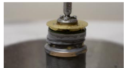
Die Schleif- und Poliermaschine hat Wernersson selbst gebaut. Mit ihrer Hilfe erhalten die Glaselemente ihre jeweilige finale Form.
