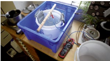
Um das Objektiv widerstandsfähig, rostfrei und haltbar zu machen, werden die Tubus-Teile zuerst anodisiert (links) und später eingefärbt (rechts).
