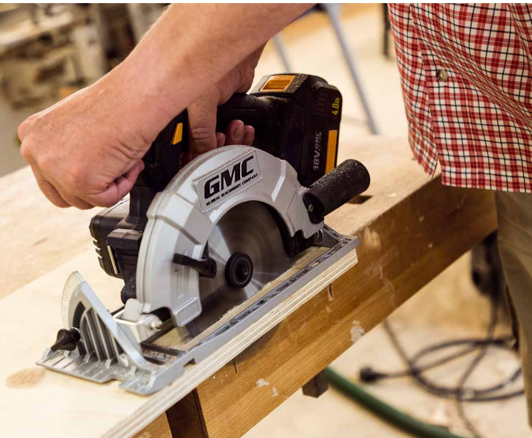
Der massive Gussfuß der GMC-Säge hinterlässt einen soliden Eindruck
