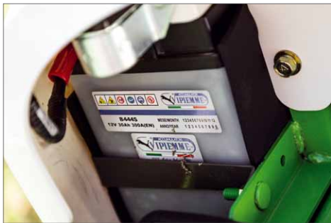
Hinter der Lenksäule befindet sich die Starterbatterie
