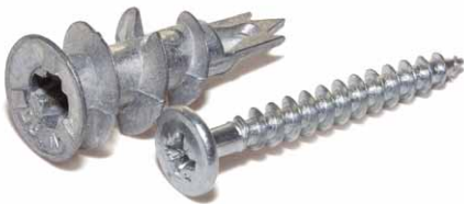
Die einfachen Gipskartondübel sind von verschiedenen Herstellern erhältlich und können meist Lasten bis ca. 5 Kilogramm halten
