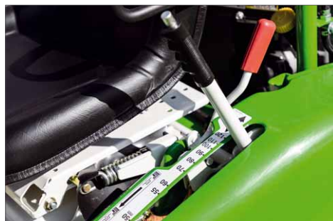
Die Schnitthöhenverstellung befindet sich auf der linken Seite und ist gut zu bedienen
