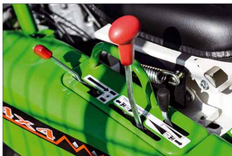
Bei der Arbeit empfiehlt es sich, den Mäher mit der Handgassteuerung zu fahren, weil diese im Gelände besser zu dosieren ist
