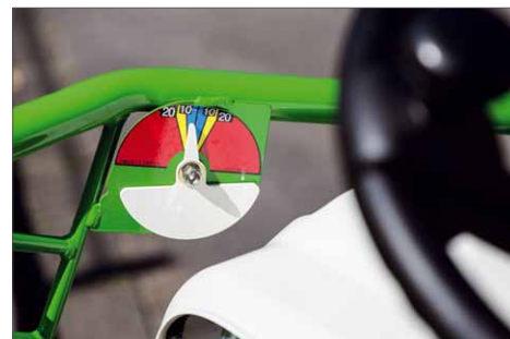
Die Neigungsanzeige ist zwar denkbar einfach aufgebaut, erhöht die Sicherheit im Betrieb jedoch erheblich
