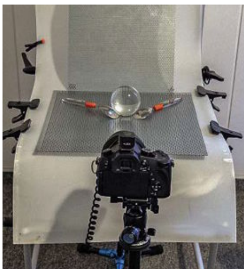
Aufbau: Die Lochbleche belichten Sie auf dem Fototisch von unten mit einem Blitz.
