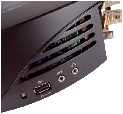
An der hinteren rechten Seite befinden sich weitere Anschlüsse, inklusive des USB-Ports, über den der Chromecast Strom beziehen kann
