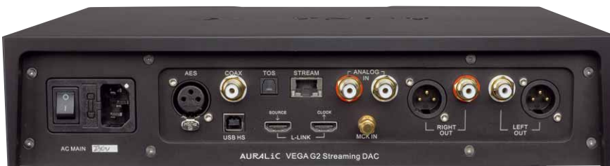
Große Anschlussvielfalt auf der Rückseite bei Ein- und Ausgängen. Allein einen I²S-Anschluss könnte man noch vermissen
