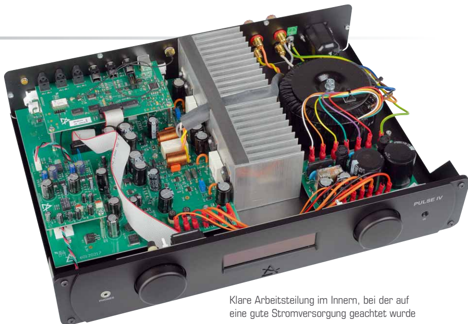
Alle digitalen Anschlüsse wurden mit dem passenden Board von der Hauptplatine getrennt
