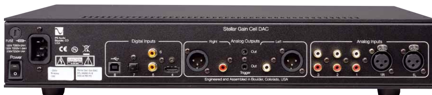
Ein- und Ausgangssektionen des DACs sind klar in digital und analog unterteilt
