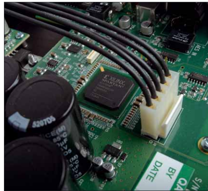
Ein aufwendig designerter FPGA-Chip kümmert sich um die Wandlung im Merlot
