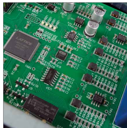
Der ESS-DAC-Chip ermöglicht eine große Bandbreite an möglichen Abtaststraten
