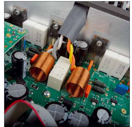
Direkt am silbernen Kühlkörper sitzen die Endstufen des Pulse
