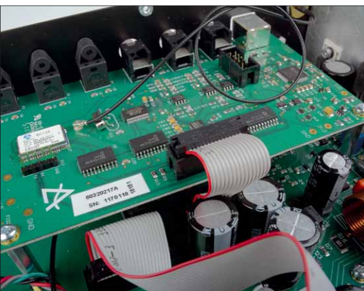
Alle digitalen Anschlüsse wurden mit dem passenden Board von der Hauptplatine getrennt
