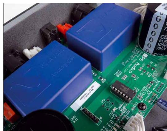
Während die Eingangsstufe der S300 auf einer Class-A-Schaltung basiert, ist die Ausgangsstufe nach Class-D konzipiert
